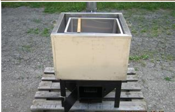
Vyvážení vosku z voští, na všechny typy rámků, topení: dřevo/plyn.
